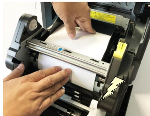
7. Setzen Sie den Aufwickelkern des Farbbandes auf den Drucker auf. Führen Sie den Vorsprung an der linken Seite des Wickelkerns in die dafür vorgesehene Öffnung des Druckers ein und setzen Sie anschließend die rechte Seite in den Halter derselben Farbe (Gelb) ein.
