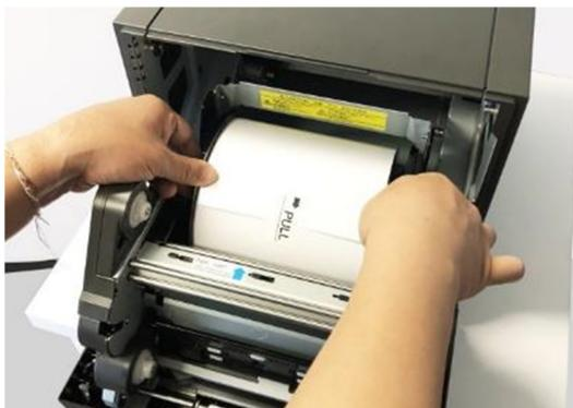
4. Entfernen Sie das Klebeband, mit dem das Papier auf der Rolle fixiert ist, und führen Sie das Papier ein.
